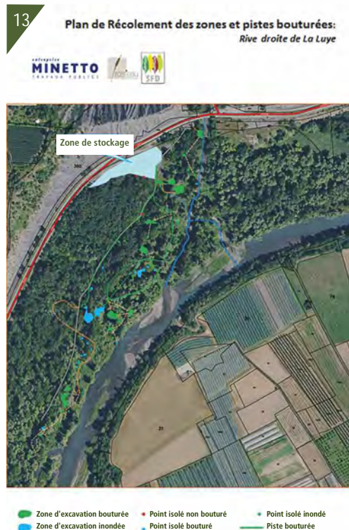
13 - Plan de récolement des zones bouturées sur la rive droite de la Luye.
