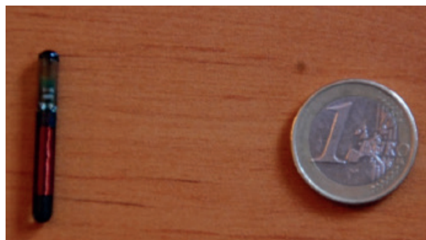
Pittag (ou transpondeur) de 32mm ©FD62
