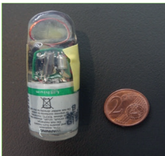
Emetteur actif de marque ATS inséré dans la cavité abdominale du brochet ©FD62
