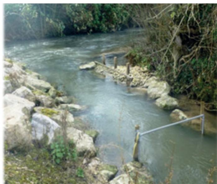
Cadre de détection installé en milieu naturel (sortie d'un bras de contournement) ©FD62
