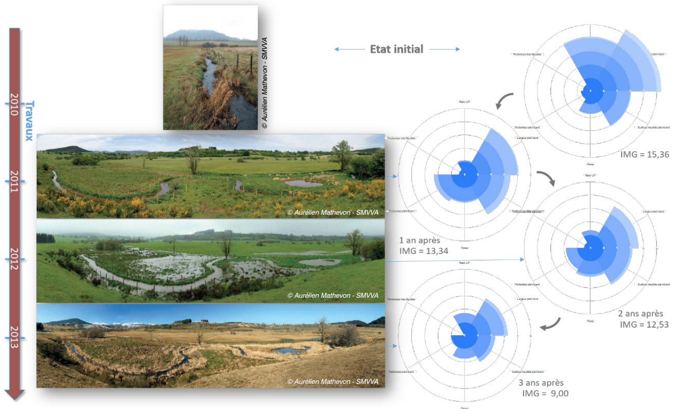
Figure 46 - Suivi de l'évolution du lit de la Veyre à partir de photographies et des indicateurs morphologiques globaux (IMG) de Carhyce. Les photos sont issues de la fiche sur la Veyre dans le classeur des retours d'expériences sur l'hydromorphologie de l'AFB [29].
